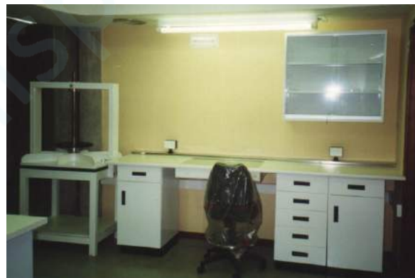
Puesto de trabajo con negatoscopio con vitrina prensa manual de 600 x 800 mm. terminal para conexiones eléctricas
